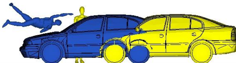
Obr. 6 Kolize chodce a automobilem o rychlosti 20 km/h (žlutý model) a 60 km/h (modrý model) – první kontakt vozidla jedoucího 20 km/h
