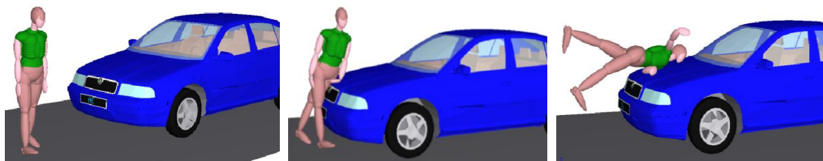
Obr. 4 Simulace střetu „Škoda Octavia Tour vs. chodec“
