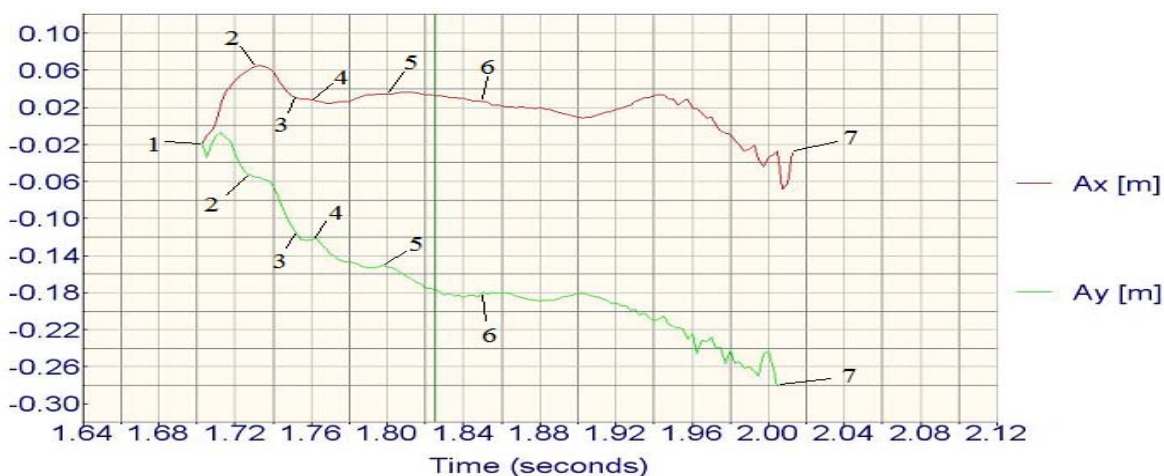
Graf 3) Znázorňuje dráhu tlaku působícího na podložku. Červený graf x představuje dráhu zevně a vnitřně (vlevo či vpravo) a zelený graf y ukazuje dráhu ve směru pohybu.
