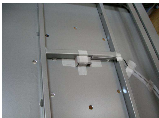
Obr.11: Senzor – akcelerometr připevněný uprostřed zesoda na diagnostické a terapeutické ploše Posturomed
