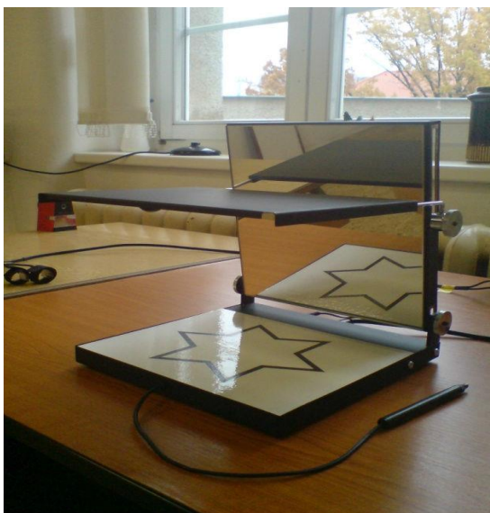
Obr. 1: Přístroj pro test zrcadlového kreslení
