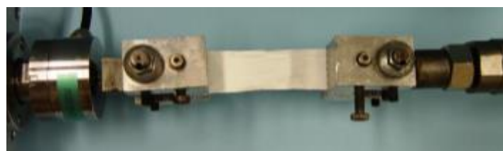
Obrázek 3 Upnutí vzorku do čelistního systému
