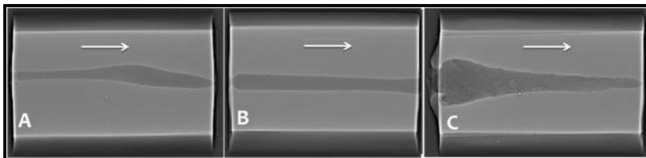
Fig. 1. Velikost dutin v náhradním materiálu - glycerínové mýdlo. Snímky pořízené počítačovou tomografií. Šipky ukazují směr letu střely [experimentální data].
