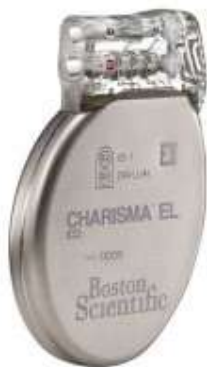
Obrázek č. 3: Příklad CIED. Rozměry a hmotnost dvoudutinového ICD (5,4 cm x 7,7 cm x 1 cm, hmotnost 71,4 g, objem 31 cm 3 ). Zdroj: (Boston Scientific)
