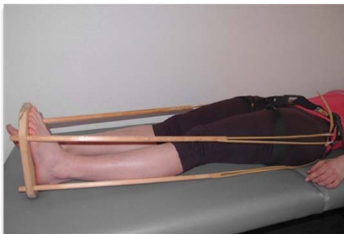
Obr. 3: MR – kompatibilní experimentální nastavení zatížení KK.
