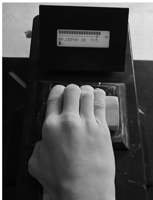
Obrázek 7. Poloha prstů na liště a displej dynamometru s vyznačenou stupnicí
