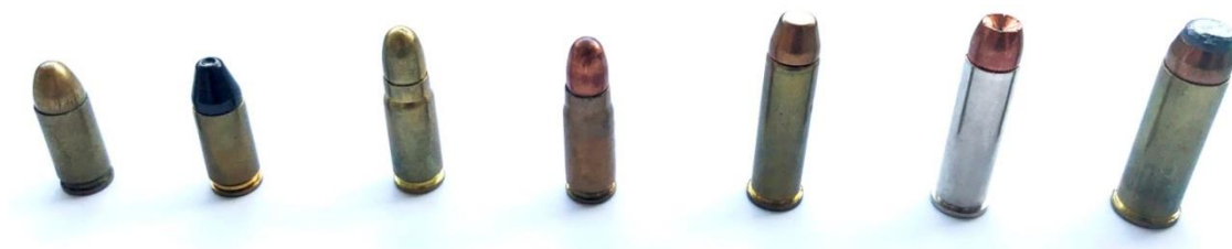
Obr. 1 Fotodokumentace použitých zbraňových systémů (zleva) - Luger 9mm, Black mamba 9 mm, Tokarev 7,62 x 25 olověné jádro, Tokarev 7,62x25 ocelové jádro, .357 Magnum 9mm., Gold Dot 9 mm, .44 Remington Magnum [experimentální data]
