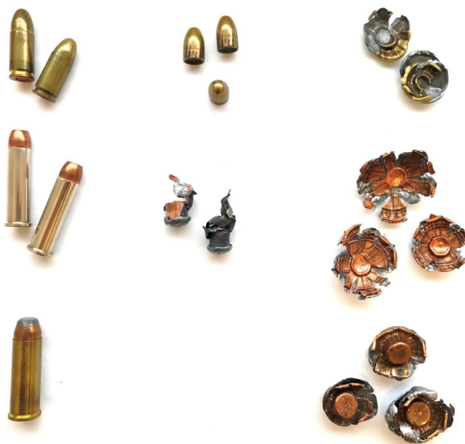
Obr. 2 Ukázka použitých zbraňových systémů a jejich deformace vzhledem k použitému materiálu. V prvním sloupci poukazuje na náboj v základním konstrukčním uspořádání. Druhý sloupec charakterizuje zásah munice do náhradního materiálu (konkr. želatinový blok/glycerínové mýdlo), v třetím sloupci vidíme střelu vyjmutou z balistické ochranné pomůcky po její kompletní deformaci [experimentální data]
