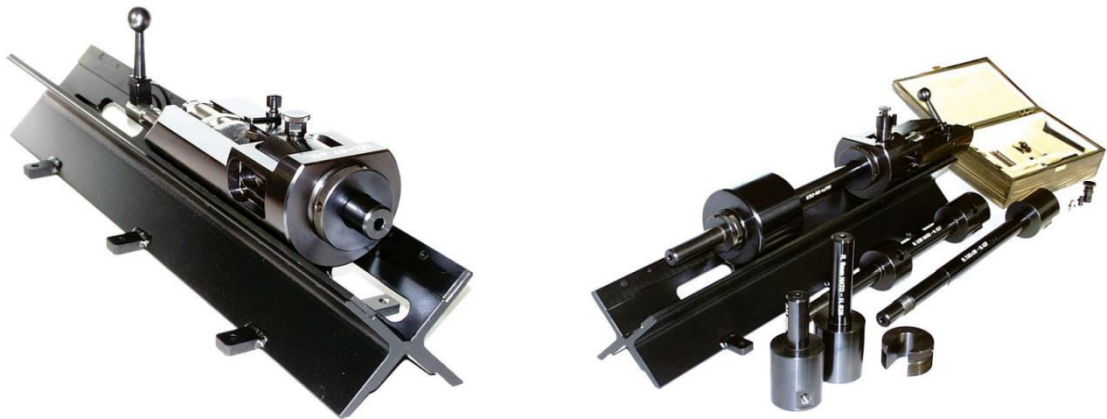
Obr. 64 Balistický uzávěr UZ-67 jako alternativa použité zbraně [experimentální data]
