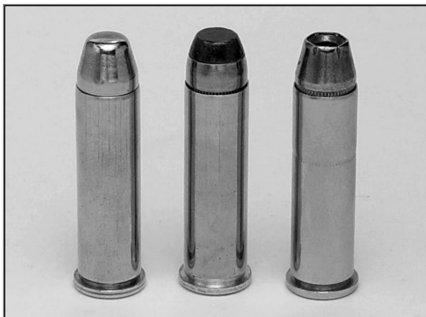
Obr. 10 Revolverové náboje ráže .357 Magnum se střelou celoplášťovou - FMJ (vlevo), polopášťovou - SP (uprostřed) a expansivní - HP (vpravo) (Jučíček, 2000)
