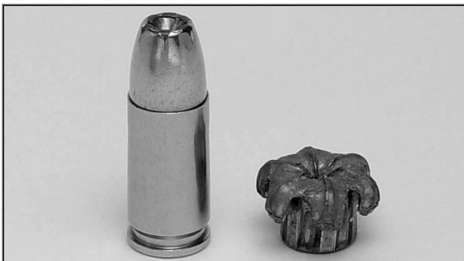
obr. 11 Pistolový náboj ráže 9 mm Luger s expanzivní střelou Gold Dot (vlevo) a expandovaná střela po proniku želatinovým zkušebním blokem (vpravo) (Juříček, 2000)
