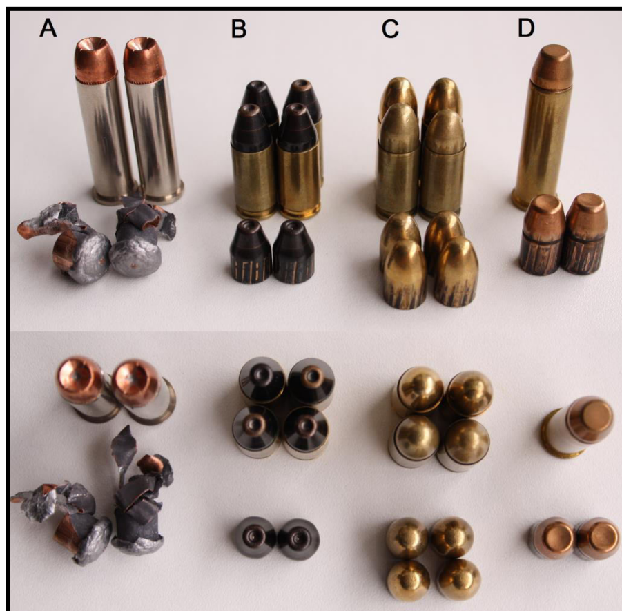
Obr. 40 Similarita deformace nábojů v glycerínovém mýdle (vlevo) a v balistické želatině (vpravo). A) Magnum .357 Gold Dot B) Black Mamba 9 mm C) Luger FMJ D) Magnum .357 FMJ [experimentální data]
