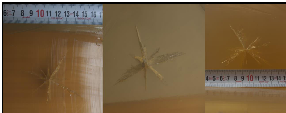
Obr. 33 Radiální trhliny vytvořené střelou LUGER 9 mm FMJ v řezu blokem balistické želatiny [experimentální data]
