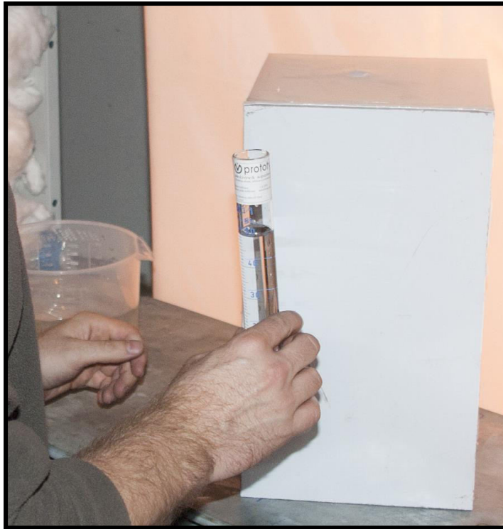
Obr. 38 Na obrázku je patrna nádoba na vodu, normovaná odměrka s tekutinou a balistický blok z glycerínového mýdla se vstupním otvorem [experimentální data]
