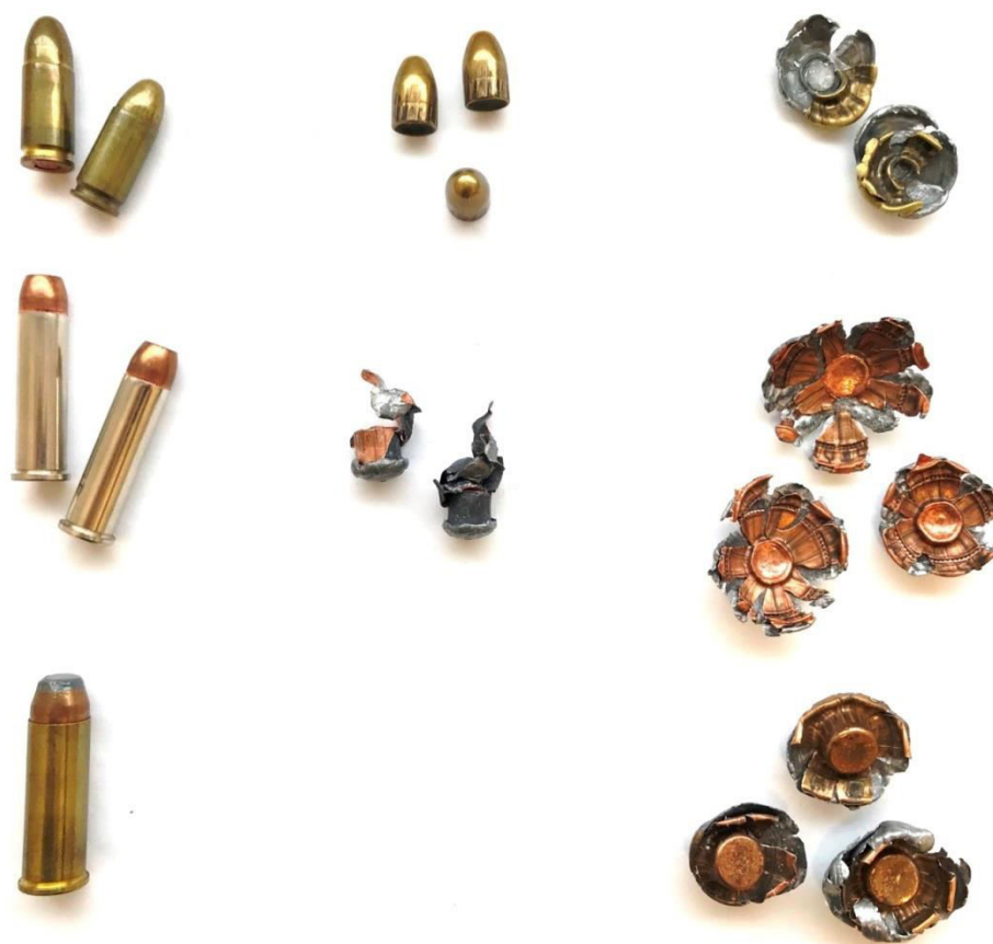
Obr. 20 Ukázka použitých zbraňových systémů a jejich deformace vzhledem k použitému materiálu. V prvním sloupci poukazuje na náboj v základním konstrukčním uspořádání. Druhý sloupec charakterizuje zásah munice do náhradního materiálu (konkr. želatinový blok/glycerínové mýdlo), v třetím sloupci vidíme střelu vyjmutou z balistické ochranné pomůcky po její kompletní deformaci [experimentální data]
