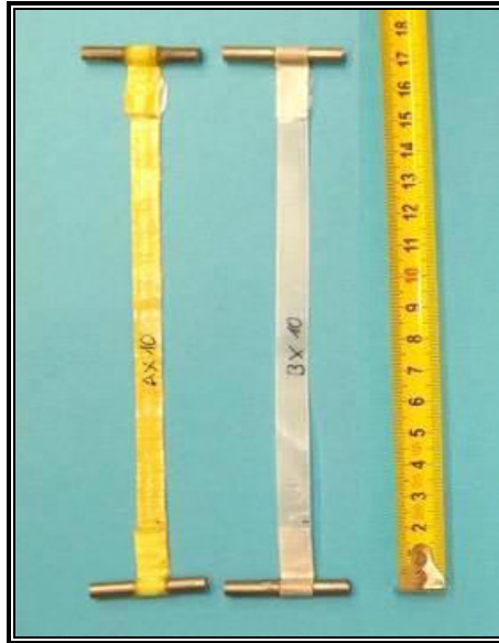
Obr. 52 Vzorky tkanin A a B šířky 10mm, odebraných ve směru x [experimentální data]
