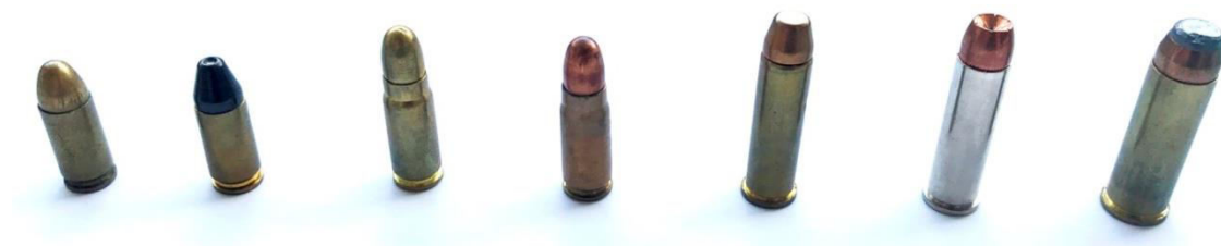
Obr. 19 Fotodokumentace použitých zbraňových systémů (zleva) - Luger 9mm, Black mamba 9 mm, Tokarev 7,62 x 25 olověné jádro, Tokarev 7,62x25 ocelové jádro, .357 Magnum 9mm., Gold Dot 9 mm, .44 Remington Magnum [experimentální data]
