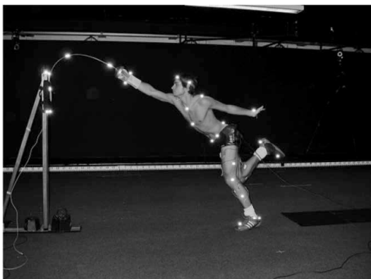
Obrázek 1: 3 D kinematická analýza pohybu pasivním systémem pomocí infračerveného odrazu světla od bodů na těle šermíře (Chèze, 2014).
