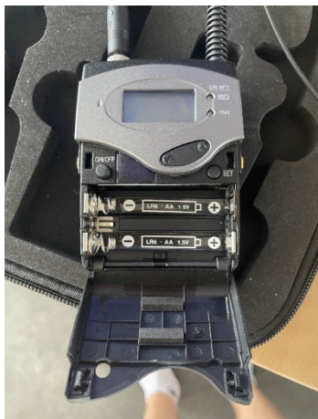
Obrázek 7. Schéma vložení baterií
