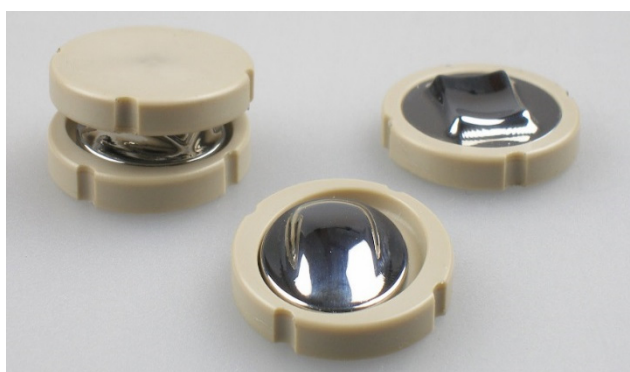
Obr. 5-18 Vzorke prototypů pro mechanické zkoušky v laboratoři na ČVUT FS, vyrobené z koncových materiálů (CoCrMo, PEEK)
