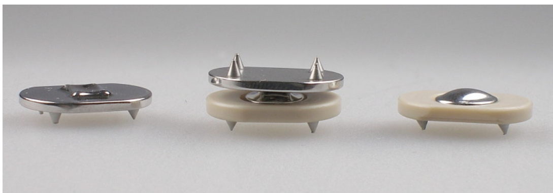
Obr. 5-17 Testovací vzorky pro FTVS UK, vyrobené z koncových materiálů (CoCrMo, PEEK)
