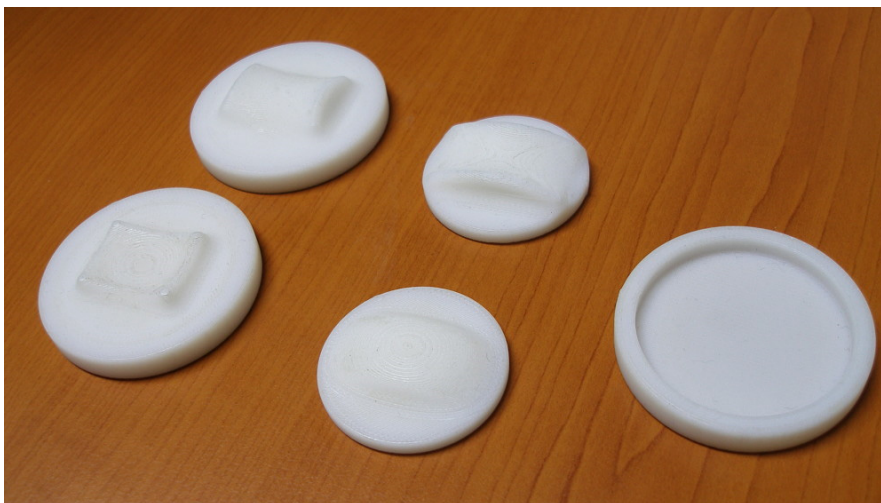
Obr. 5-10 Modely předběžných náhrad meziobratlového disku – rapid prototypy z polymerového 3D tisku.
