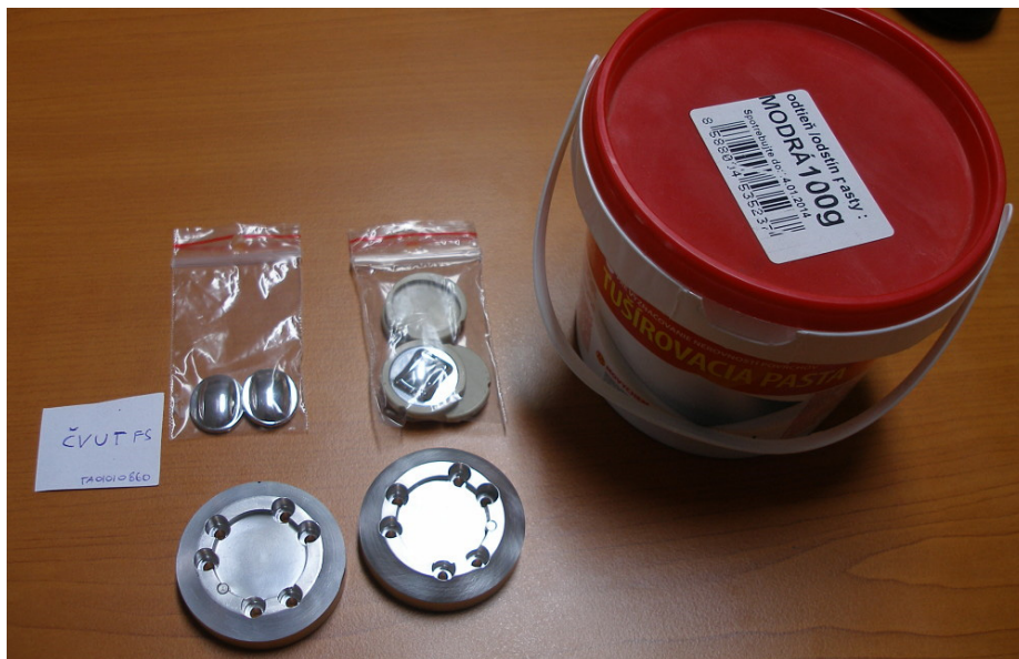
Obr. 5-19 Testovací vzorky pro mechanické zkoušky v Laboratoři biomechaniky ČVUT FS.
