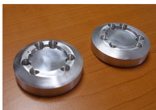
Obr. 4-8 Vlevo: nástavec pro upnutí do zkušebního stroje – model, získaný 3D tiskem (před výrobou kovového vzorku vyzkoušen přímo na testovacím stroji). Vpravo: vyrobené kusy nástavce z koncového materiálu – duralu, pro mechanické testy.
