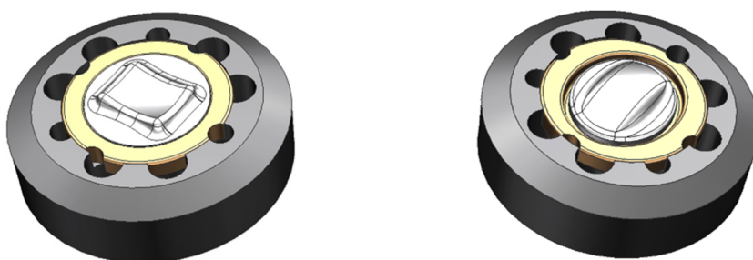
Obr.4-7 Náhledy 3D modelů sestav horní (vlevo) a spodní části nástavce pro upnutí do zkušebního stroje v Laboratoři biomechaniky ČVUT FS, obsahující i modely odpovídajících artikulárních komponent testovacích vzorků experimentální náhrady meziobratlového disku.
