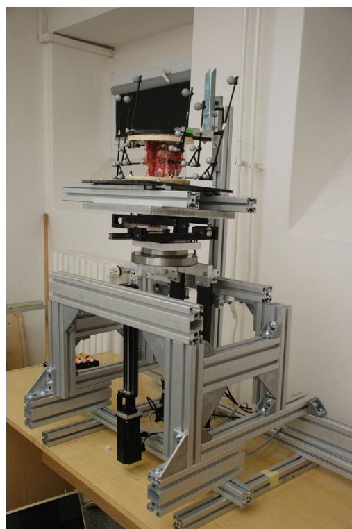
Obr. 4-10 Kadaverický vzorek páteřního segmentu, osazený konzolemi s markery v zařízení, které bylo zkonstruováno pro účely těchto experimentálních měření v rámci grantového projektu TA01010860.
