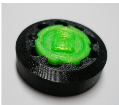
Obr. 4-8 Vlevo: nástavec pro upnutí do zkušebního stroje – model, získaný 3D tiskem (před výrobou kovového vzorku vyzkoušen přímo na testovacím stroji). Vpravo: vyrobené kusy nástavce z koncového materiálu – duralu, pro mechanické testy.
