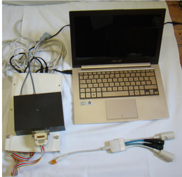
Obr. 5.3.2 Pracovní zapojení měřicí stanice VisionBrain, v popředí upravený kabel určený k napojení na výstup X-10 monitoru.
